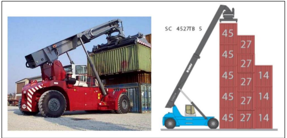
Figura 2.26: Sección típica de un equipo Reach-Stacker.[20]
