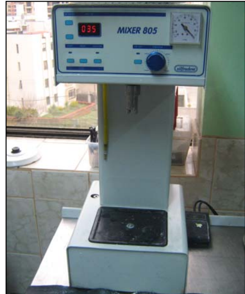
Figura XI: Mezcladora al vacío y espatulado mecánico del yeso.
