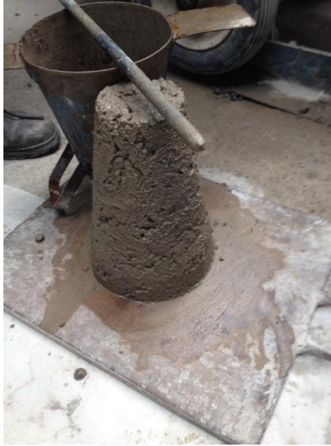
Figura 5.3.- Ensayo de asentamiento Fuente: Elaboración propia
