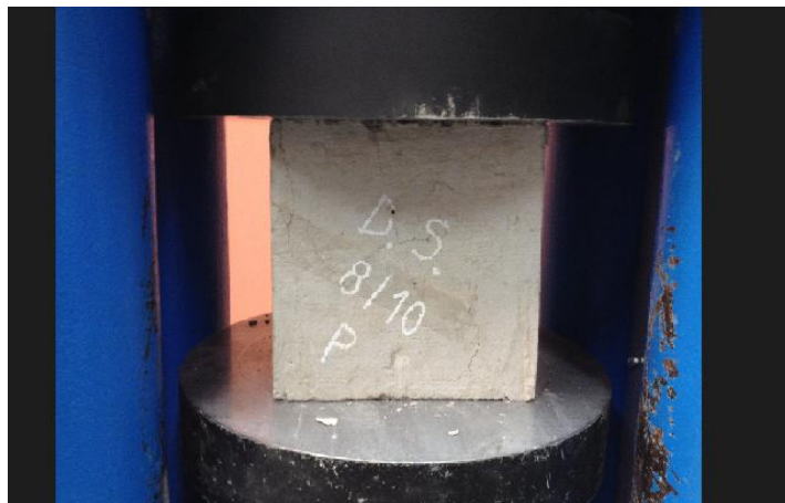
Figura 5.2.- Probeta patrón ensayada en laboratorio Fuente: Elaboración propia
