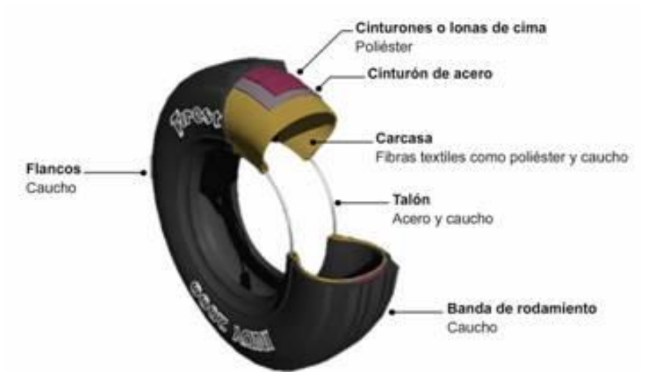
Figura 3.1.- Partes del Neumático Fuente: Revista Química Viva, 2011
