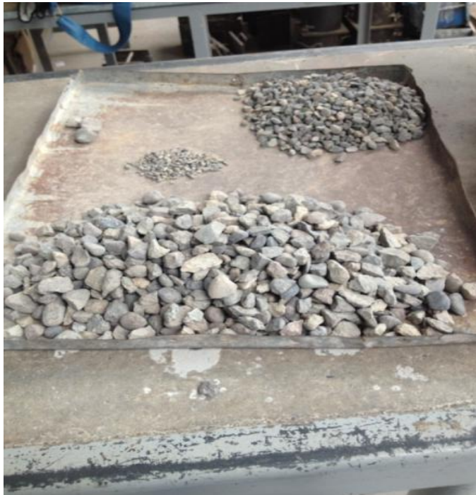
Figura 4.6.- grava tamizada y pesada Fuente: elaboración propia
