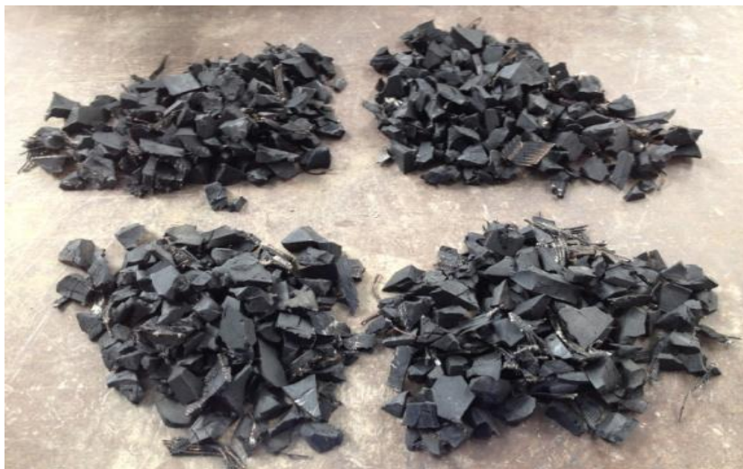
Figura 4.8.- Cuarteo Caucho Reciclado para Granulometría Fuente: elaboración propia
