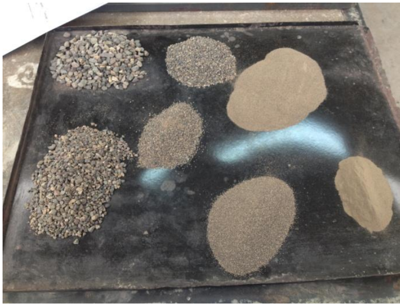
Figura 4.3.- Arena tamizada y pesada Fuente: elaboración propia
