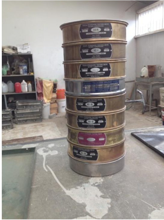
Figura 4.2.- tamizado arena en laboratorio Fuente: elaboración propia
