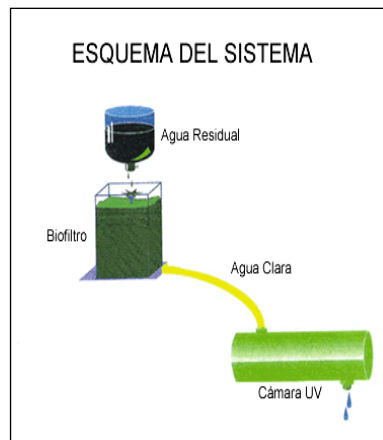
Figura N°9: Esquema del Sistema de Tratamiento de Aguas Residuales, Tohá.
