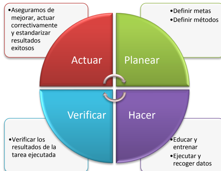
Figura 1. 5 Ciclo (PHVA) Planear, Hacer, Verificar y actuar sobre sus procesos. Ciclo de Shewhart – Deming
