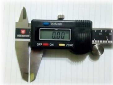
Figura 4.22 Pie de metro con sensibilidad de 0,01mm.
