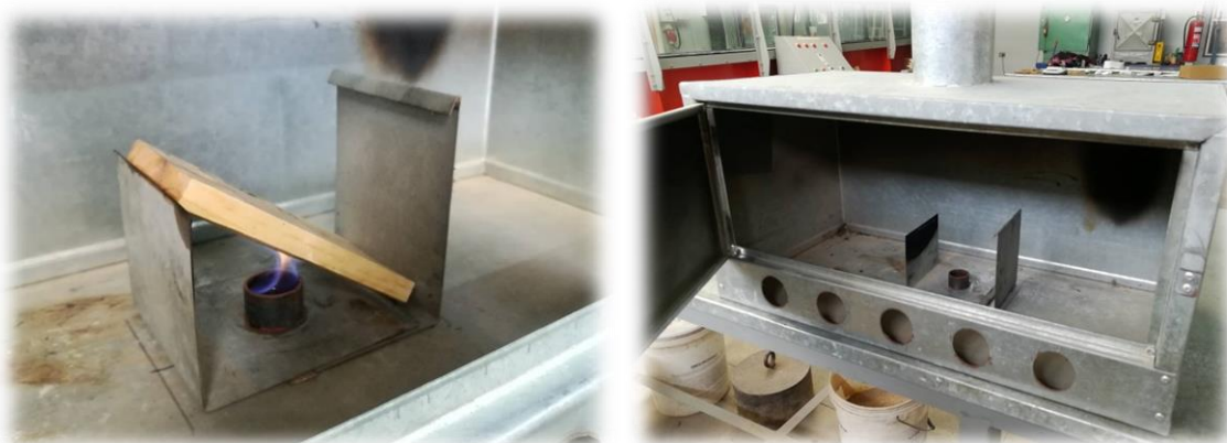
Figura 4.25 Cámara de ensayo retardo al fuego.
