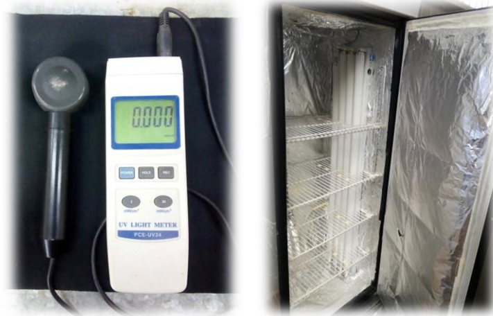
Figura 4.21 Radiómetro en mW/cm^2 y cámara de envejecimiento.
