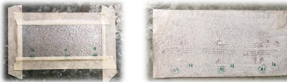
Figura 4.24 Puntos a ensayar y enrejado resultante de adherencia.
