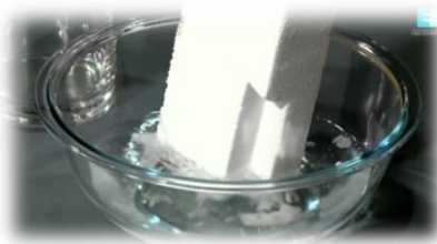
Figura 2.1 EPS disolviéndose en solvente.
