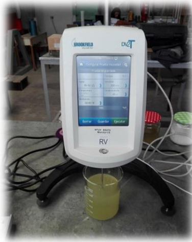
Figura 4.17 Viscosímetro utilizado para la realización del ensayo.
