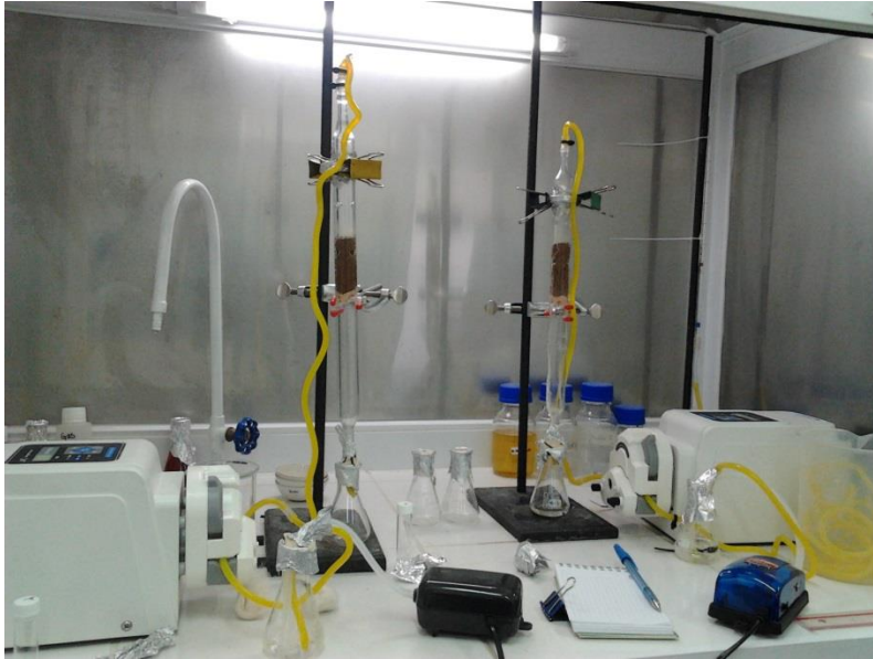
Figura 9 - Proceso de BDS en un Bioreactor Experimental Continuo.
