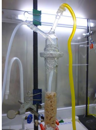
Figura 10 - Modificación estructural del BEC para favorecer la oxigenación del lecho catalítico.
