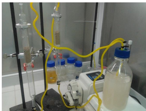
Figura 8 – Proceso de Adsorción in situ de Rhodococcus Rhodochrous en un BEC (izquierda), en partículas calcinadas de Sepiolita.
