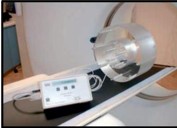
Figura 10.1 Disposición para la medición del índice kerma en aire TC, C_{PMMA,100,c} en el fantoma estándar de cabeza. El fantoma es posicionado en la camilla y la cámara es posicionada en el agujero central del fantoma. El protector plástico se coloca en la cámara para asegurar un buen calce dentro del fantoma. El plano central del fantoma aún no se encuentra alineado con la posición del corte a realizar. En la práctica el fantoma puede ser asegurado con una cinta adhesiva.
