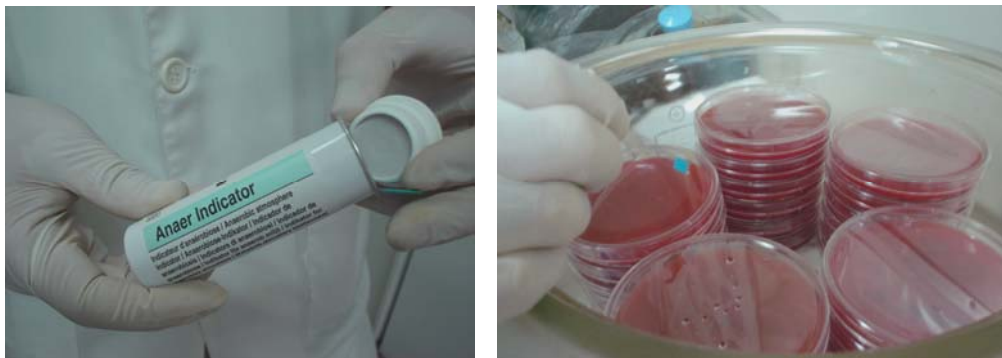
Foto 5. Indicador de Anaerobiosis, introducción en la Jarra.
