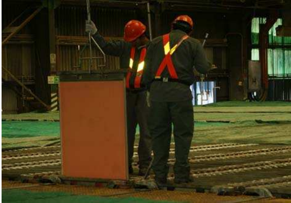
Figura 4.4 – Fotografía de levantamiento cátodo por operador. Fuente: (CODELCO, 2013)
