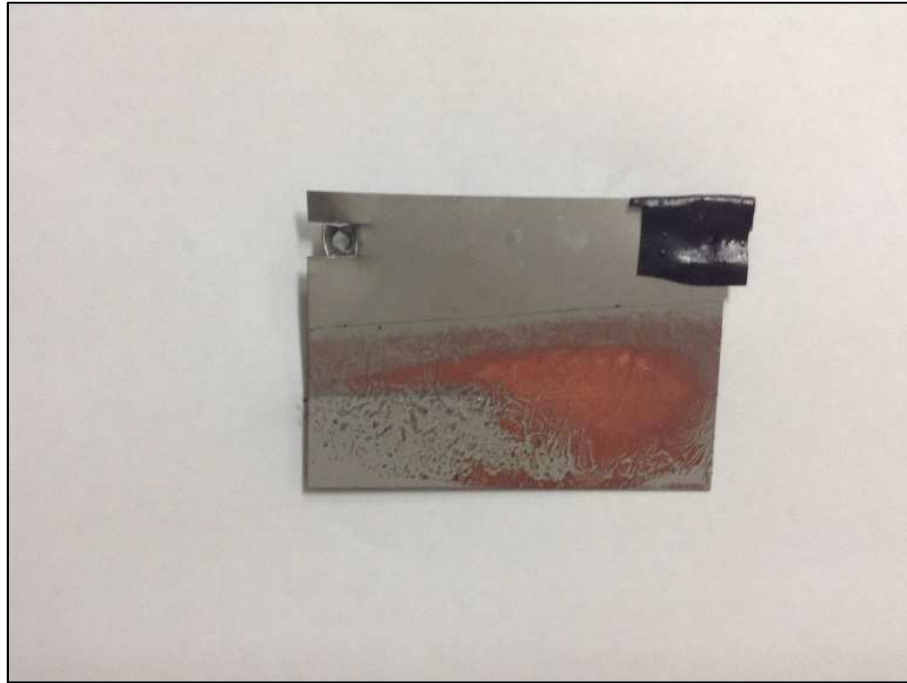
Figura 7.4 – Fotografía de ánodo celda en paralelo. Fuente: (Elaboración propia)
