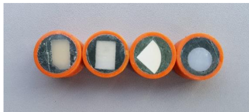
Fig. 12: Preparación de la muestra. A) PVC con compuesto de modelar, B) Cuerpo de cerámica ajustado en el compuesto de modelar, C) Lijado en lija 600 del cuerpo cerámico.
