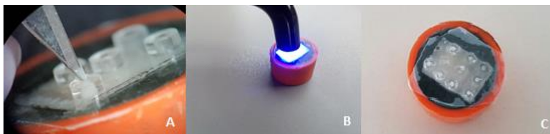
Fig. 18 : Restauración de los cuerpos de muestras con Variolink II. A)Aplicación del cemento con bisturí n°11; B)Fotopolimerización; c) Cuerpo completamente restaurado.
