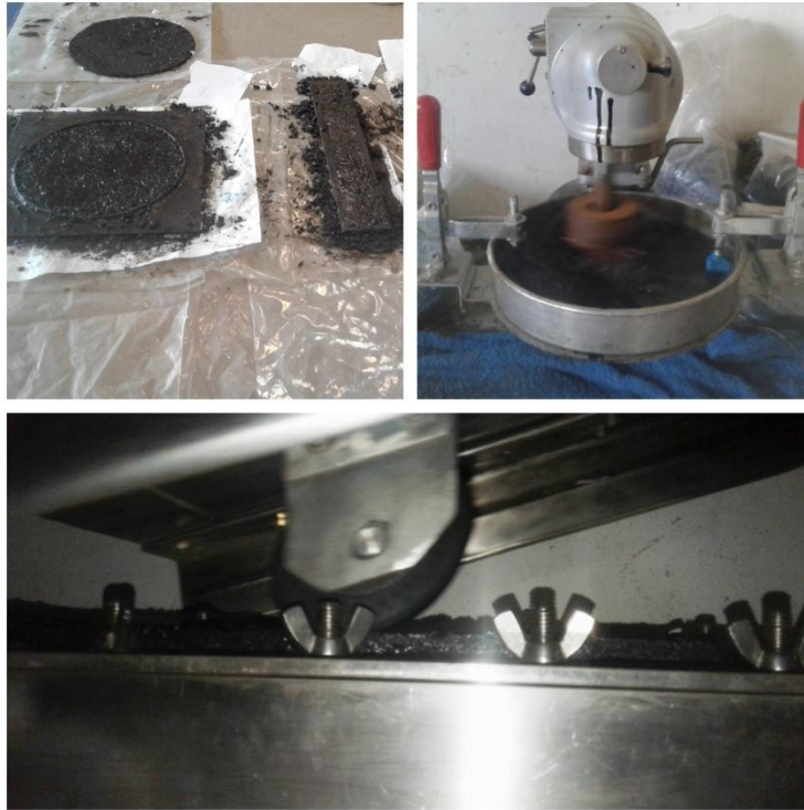
Ilustración 0.2 “Ensayo de abrasión en medio húmedo y rueda de carga.” (Fuente: Elaboración propia.)
