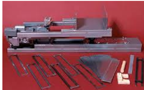
Ilustración 3.3 “Equipo de rueda de carga.” (Fuente: Curso Laboratorista MOP.)
