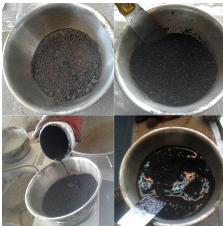
Ilustración 0.1 "Elaboración de mezclas lechadas asfálticas." (Fuente: Elaboración propia.)
