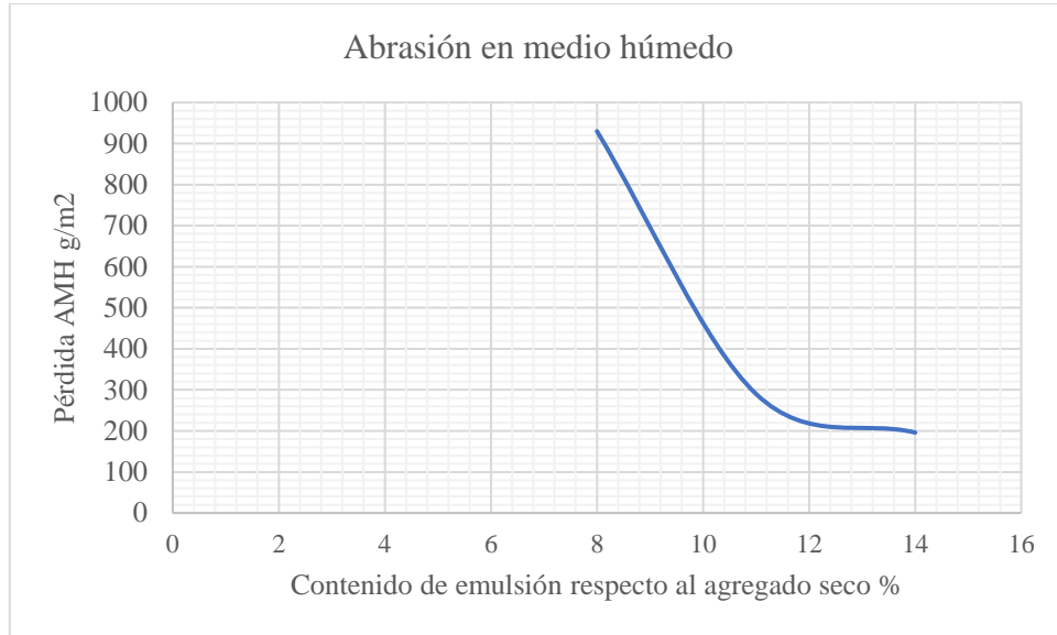
Ilustración 4.3 “Gráfico Pérdida de abrasión en medio húmedo vs Contenido de emulsión respecto al agregado seco” (Fuente: Elaboración propia.)
