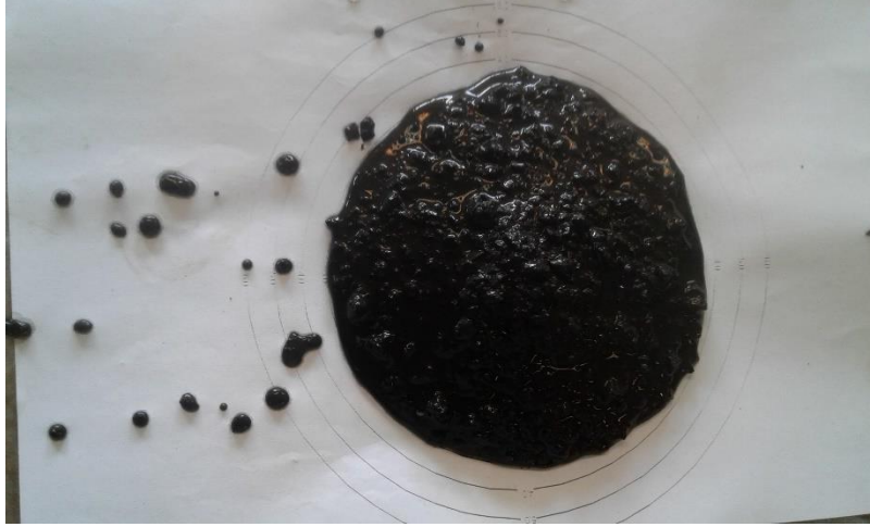
Ilustración 4.7 “Consistencia adecuada de lechada asfáltica con reemplazo total de escoria de cobre.” (Fuente: Elaboración propia.)
