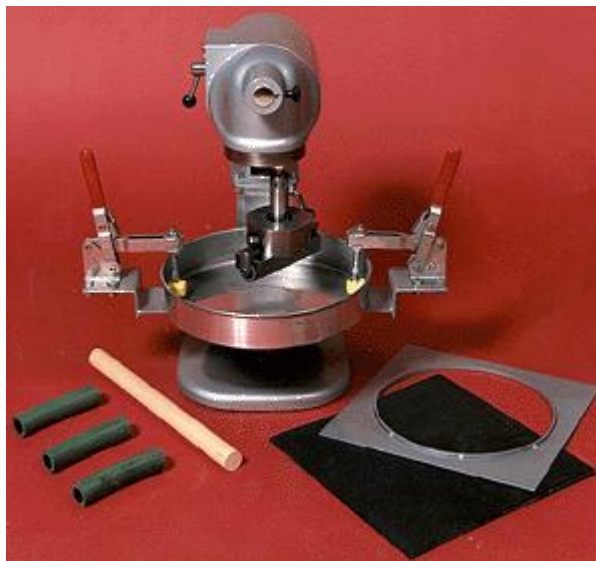
Ilustración 3.2 “Equipo de abrasión en medio húmedo.” (Fuente: Curso Laboratorista MOP.)
