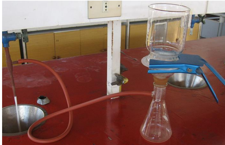
Figura 17: Sistema de filtrado al vacío de las muestras post-adsorción
