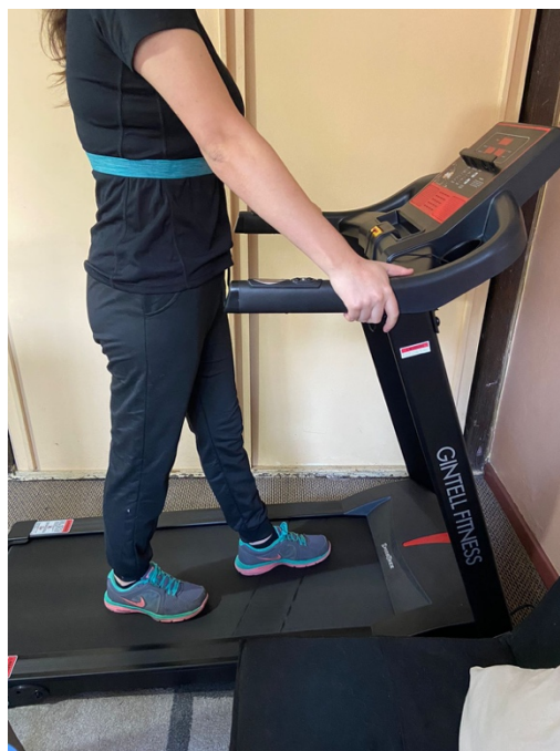
Figura 10: Imagen demostrativa del sujeto de prueba situado en la trotadora utilizando el dispositivo polar H10 (Imagen representativa, en la realidad este dispositivo debe ir debajo de la polera.)
