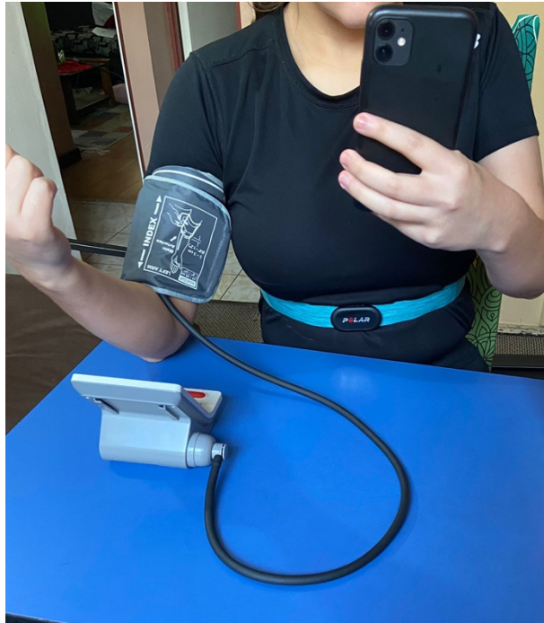
Figura 8: Imagen representativa de cómo se realizó la medición utilizando los 2 dispositivos y al mismo tiempo se procede a grabar con la cámara frontal del teléfono. Imágen tomada sólo con fines de demostración, en la realidad, el cinturón debe ir debajo de la polera.
