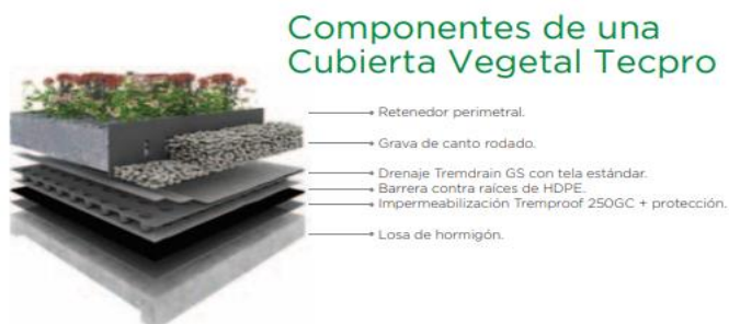
Ilustración N°16: Componentes de una Cubierta Vegetal
