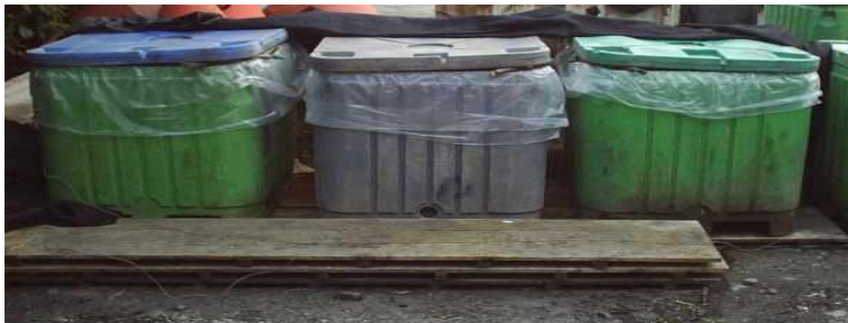
Figura 2: Contenedores en los que se realizó la experiencia de compostaje, cada uno cuenta con una capacidad de 1m 3 .
