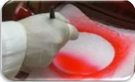
Fig. 9 Aplicación de tinte rojo mediante aerógrafo
