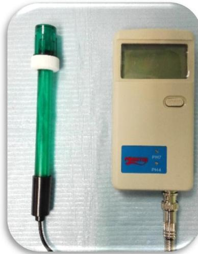
Fig. 5 Potenciómetro
