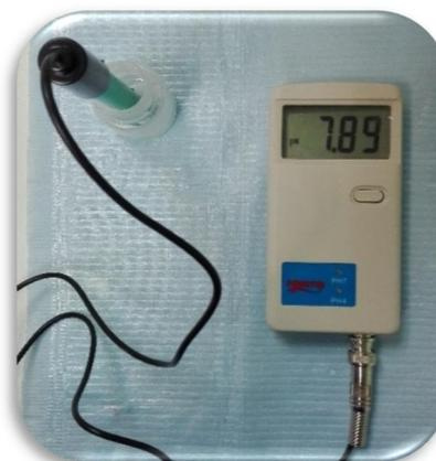
Fig. 20 Medición de pH con potenciómetro
