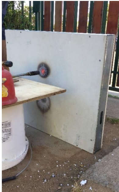
Figura 3.15. Ensayo resistencia al fuego. Fuente: Elaboración propia, 2017.
