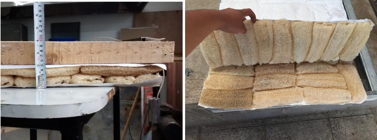
Figura 3.5. Sistema de esponja vegetal Luffa Cylindrica . Fuente: Elaboración propia, 2017
