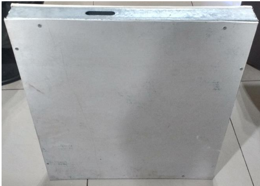
Figura 3.1. Panel con el sistema de esponja vegetal Luffa Cylindrica Fuente: Elaboración propia, 2017
