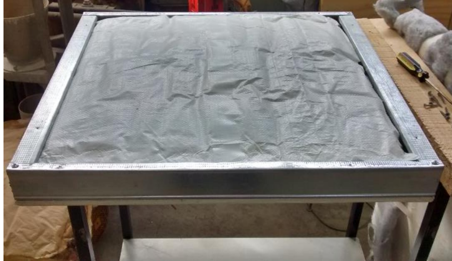
Figura 3.6. Panel con el sistema de esponja vegetal Luffa Cylindrica . Fuente: Elaboración propia, 20
