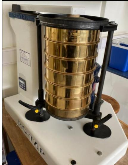
**Figura 5.4:** Agitador de tamiz.
