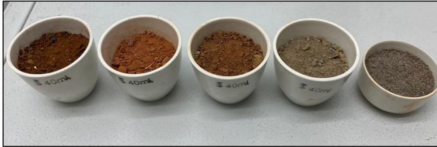
**Figura 5.5:** Determinación de materia orgánica por método de ignición.
