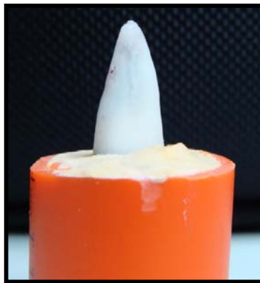
Fig. V: Diente montado en tubo de PVC con yeso piedra.
