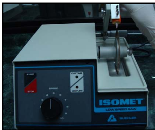
Fig. VI: Máquina ISOMET utilizada en el corte dentario.
