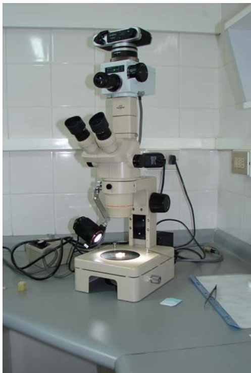
Fig. 22: Lupa estereoscópica Olympus con sistema de fotografía integrado.
