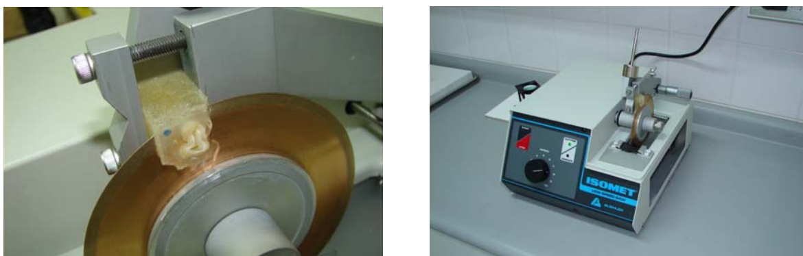
Fig. 21: Sierra de baja velocidad. Se observa el cuerpo de prueba y disco de diamante.
